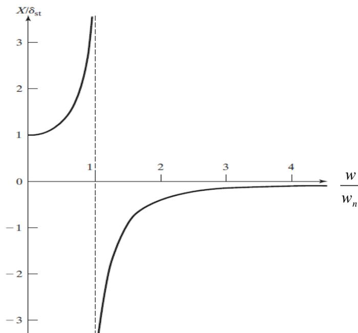
Figure 3. 2 : Facteur d'amplification pour un système non amortie [2]
