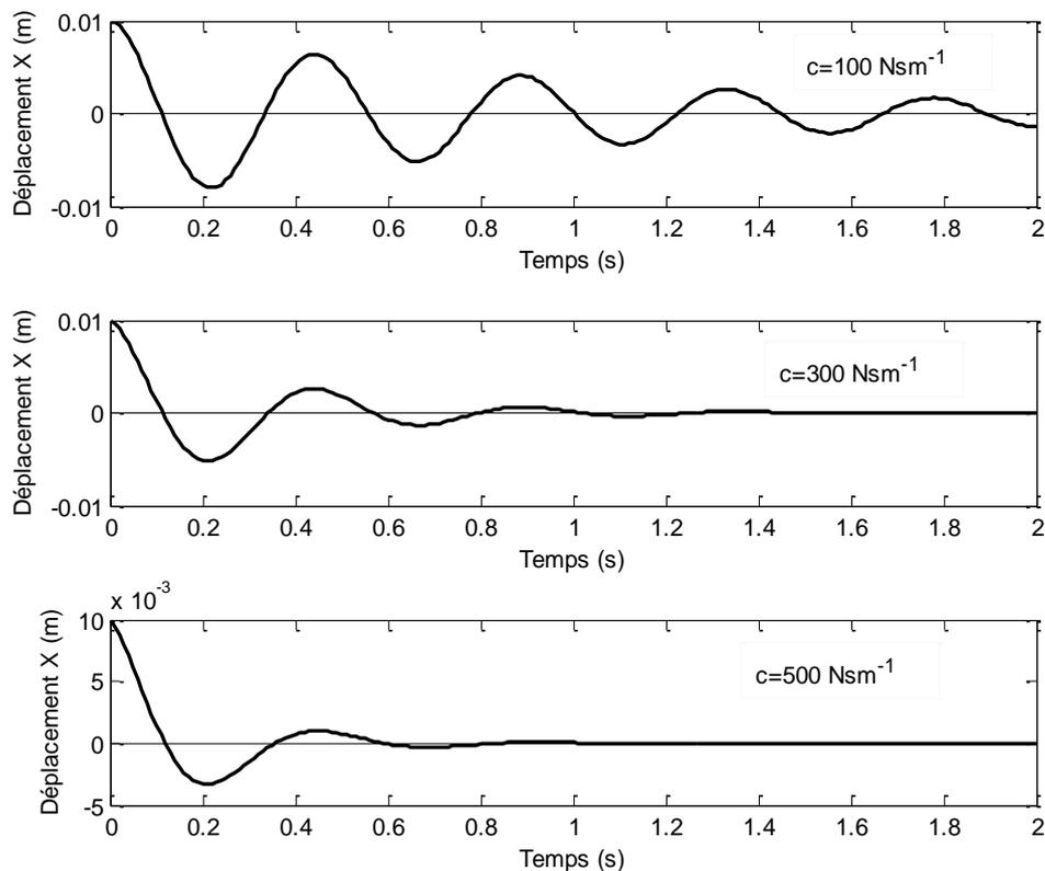
Figure 2.8 : Vibration faiblement amortie d'un système masse ressort ( $m=500$  kg,  $k=10^4$   $\text{Nm}^{-1}$ ), pour trois différentes valeurs de coefficient de frottement.
