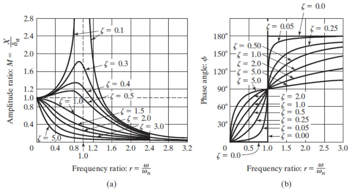
Figure 3. 8: Réponse harmonique pour un système amorti [2]
