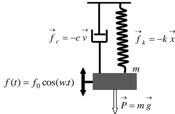
Figure 3.7 : Système excité, masse ressort amortisseur
