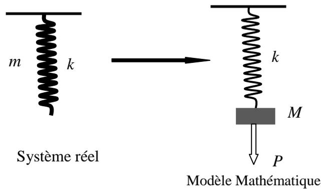
Figure 1.10 : Masse équivalente pour un ressort de masse non négligeable
