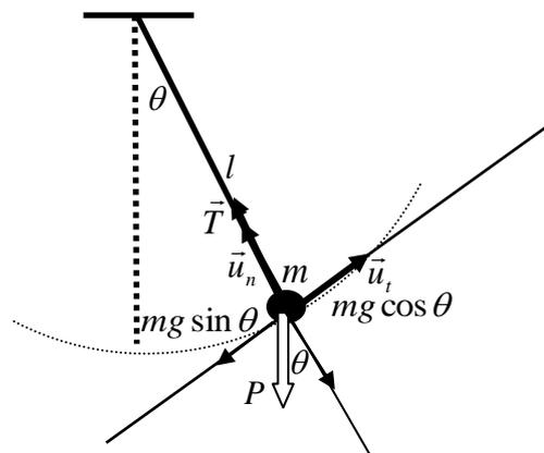
Figure 2.2 : Système à un degré de liberté : le pendule simple.
