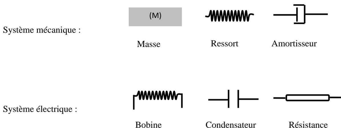
Figure 1. 1 : Représentation graphique des éléments du système vibratoire
