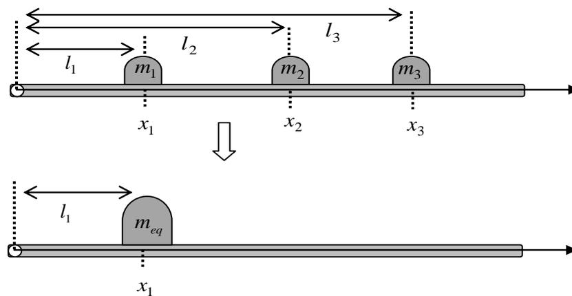
Figure 1.11 : Masse équivalente de trois masses  $m_1$ ,  $m_2$  et  $m_3$  attachées sur une barre
