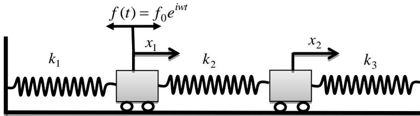
Figure 4.2 : Système forcé à deux degrés de liberté, deux masses trois ressorts
