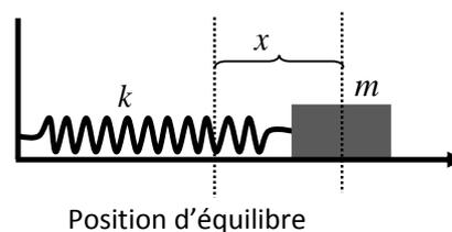
Figure 1.4 : Système masse-ressort
