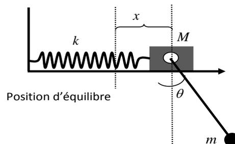
Figure 1. 6 : Système masse ressort et pendule couplés
