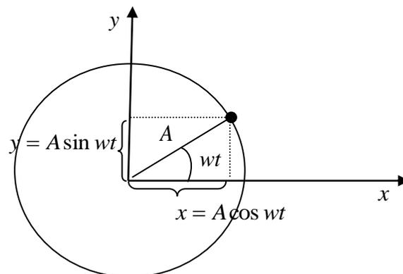
Figure 1.15 Mouvement circulaire d'un point matériel.
