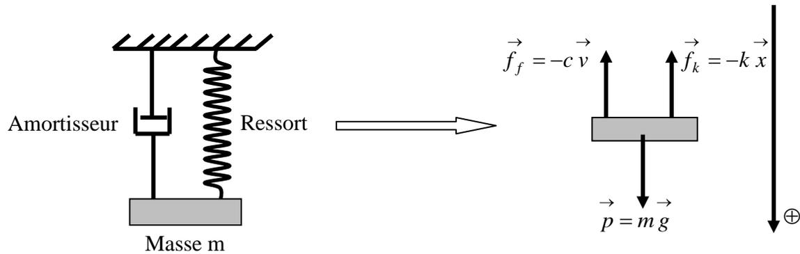
Figure 2.7 : Système amortie, masse ressort amortisseur.
