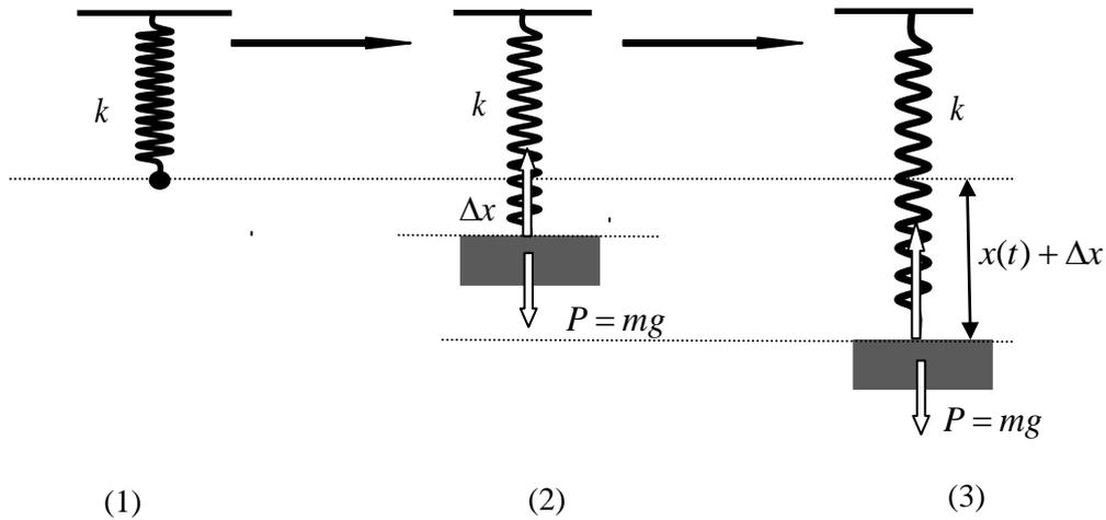
Figure 2.1 : Système masse-ressort à un degré de liberté
