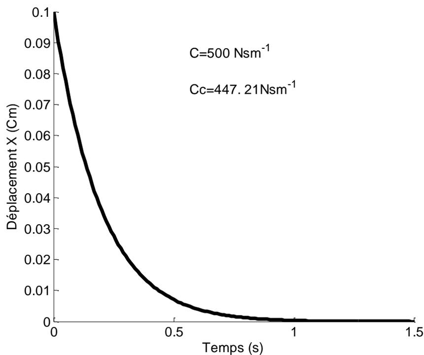
Figure 2.10 : Vibration lourdement amortie d'un système masse ressort ( $m=50$  kg,  $k=10^4$  Nm<sup>-1</sup>).
