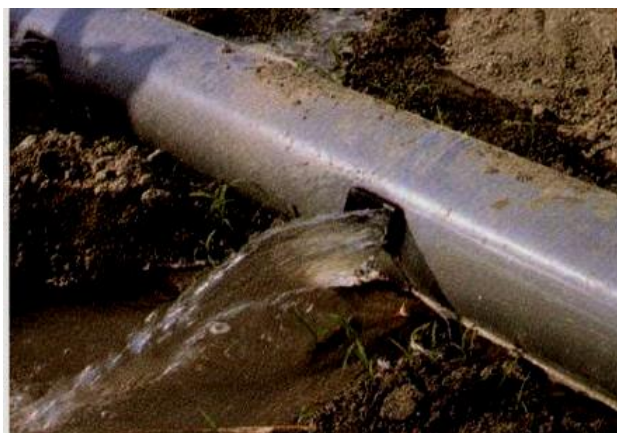
Figure IV.10. Vannette coulissantes réglant le débit dans la raie.
