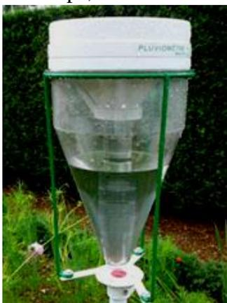
Figure II.1. Le pluviomètre
