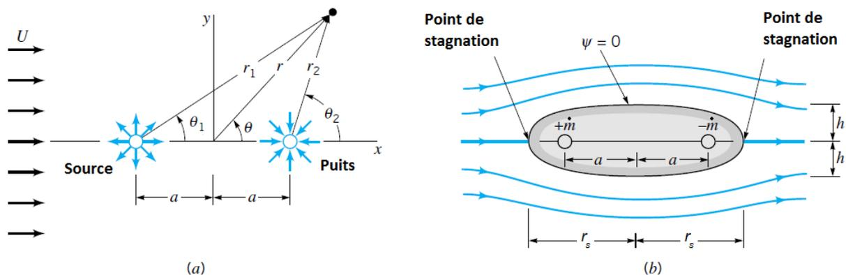
Fig.1.18 Superposition d'une source, d'un puits et d'un écoulement uniforme (a) et les lignes de courant résultantes (b).
