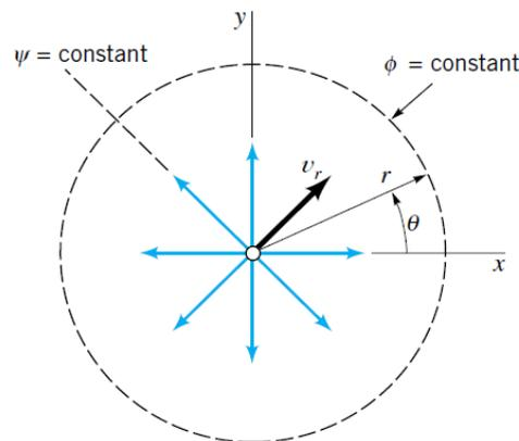
Fig.1.13 Lignes de courant et lignes équipotentiellles pour une source.
