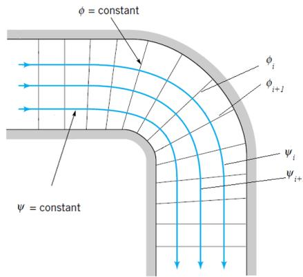
Fig.1.10 Ligne de courant et potentiel de vitesse d'un écoulement dans un coude à 90°.
