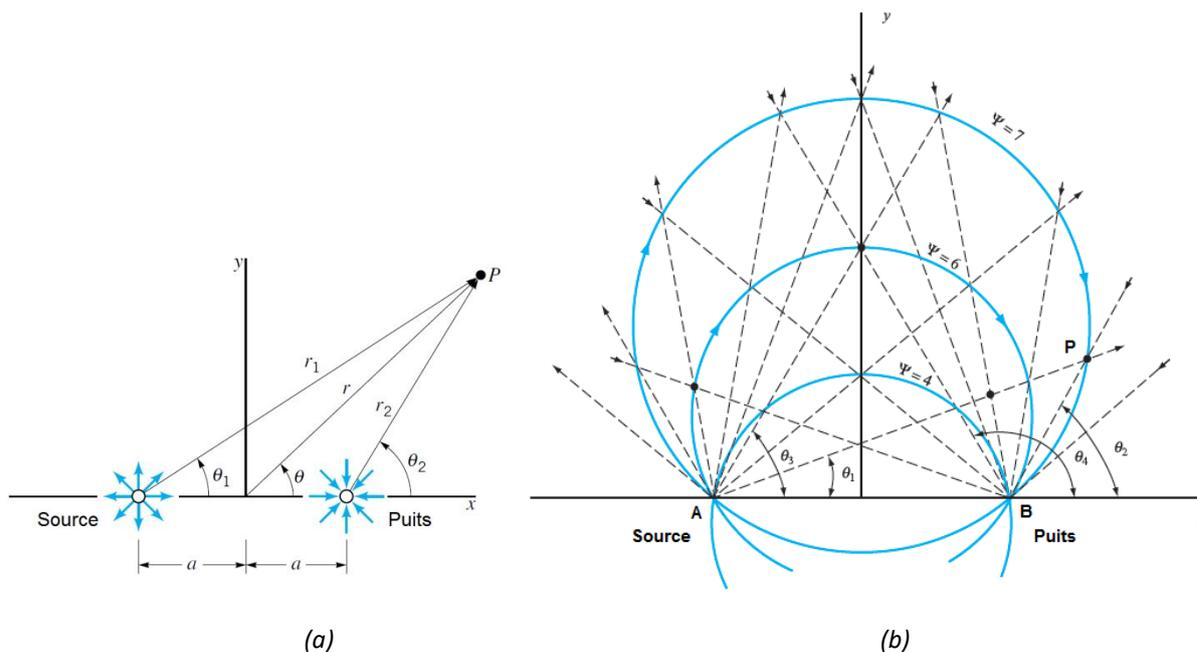
Fig.1.16 Superposition d'une source et d'un puits (a) et les lignes de courant résultantes (b).
