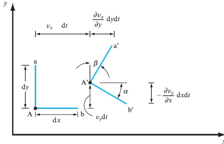
Fig.1.5 Rotation, translation et déformation d'un élément de fluide.
