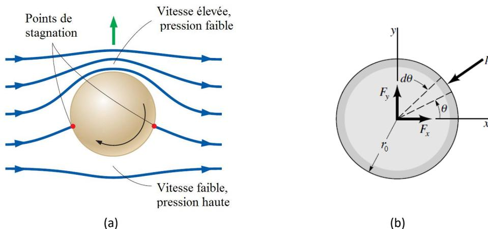
Fig.1.22 Écoulement potentiel sur un cylindre rotatif (a) et l'effet Magnus résultant (b).
