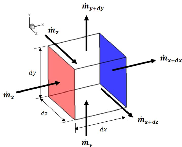
Fig.1.2 Volume de contrôle dans un champ d'écoulement
