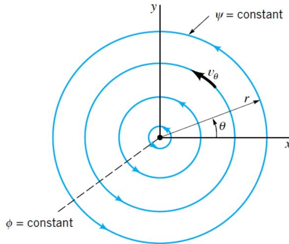
Fig.1.14 Lignes de courant et lignes équipotentielles pour un vortex.
