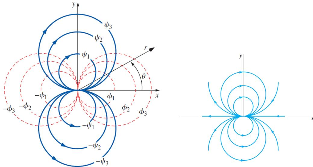
Fig.1.18 Lignes de courant et les lignes équipotentielles pour un doublet.
