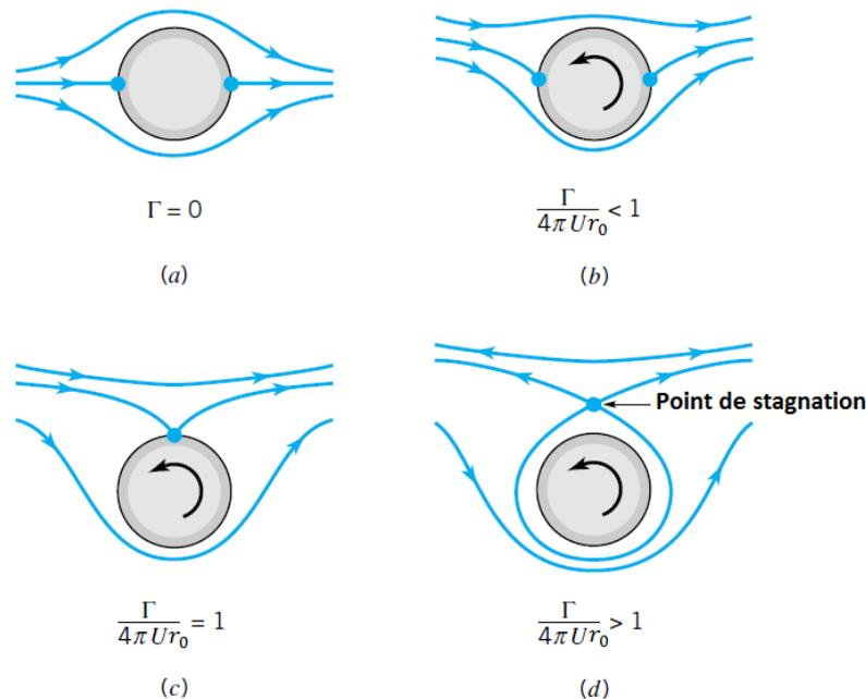
Fig.1.20 Lignes de courant de la superposition d'un doublet et d'un écoulement uniforme.
