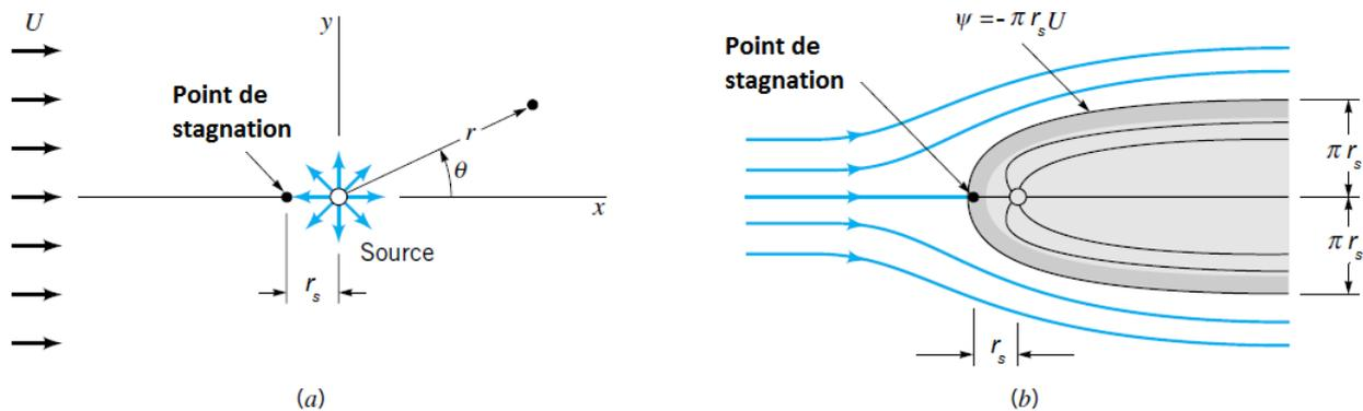
Fig.1.15 Superposition d'une source et d'un écoulement uniforme (a) et les lignes de courant résultantes (b).
