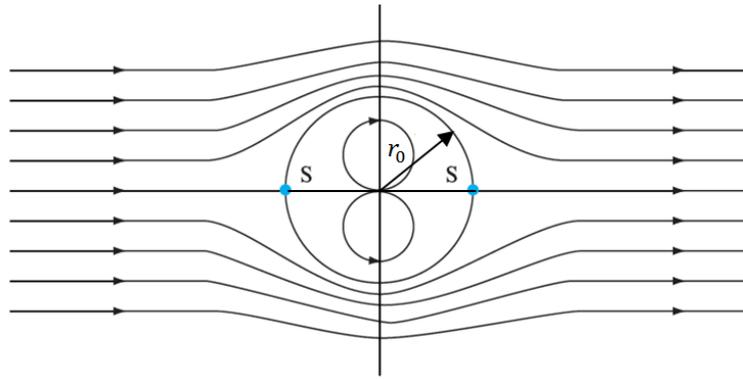
Fig.1.19 Lignes de courant de la superposition d'un doublet et d'un écoulement uniforme.
