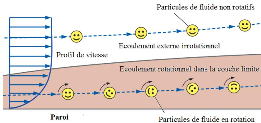
Fig.1.3 Différence entre l'écoulement rotationnel et irrotationnel.
