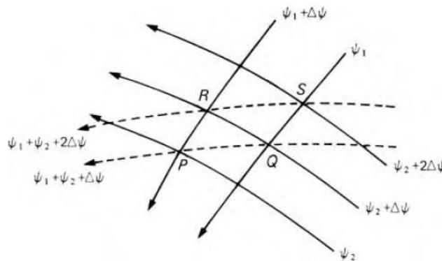
Fig.1.11 Combinaison de deux écoulements à potentiel de vitesse
