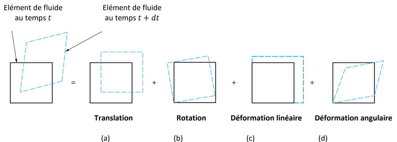
Fig.1.4 Types de mouvement et de déformation pour un élément fluide.
