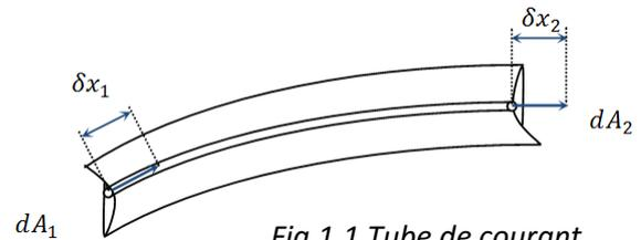
Fig.1.1 Tube de courant
