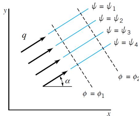
Fig.1.12 Ecoulement uniforme avec une vitesse constante  $q$  dans une direction arbitraire.
